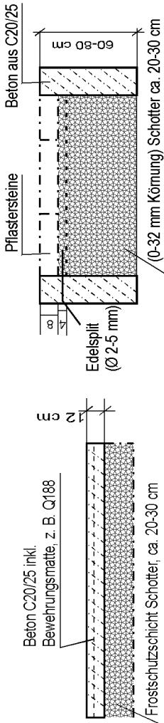
Querschnitt der Bodenplatte
